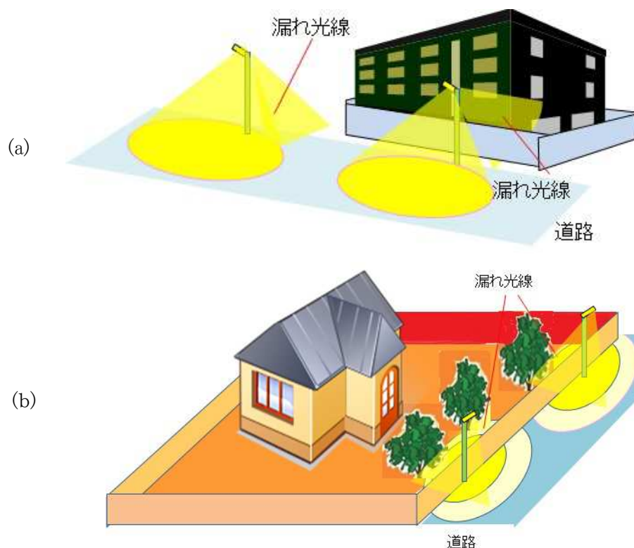
図4.マンション及び個人住宅における漏れ光線
